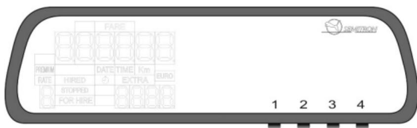
Durante questa operazione il tassametro non visualizza niente. Se la vettura e' in movimento, il tassametro registrera' la distanza percorsa sul contatore. Nella posizione "Spento" premete il tasto 1 per modificarlo nella posizione "Libero".
